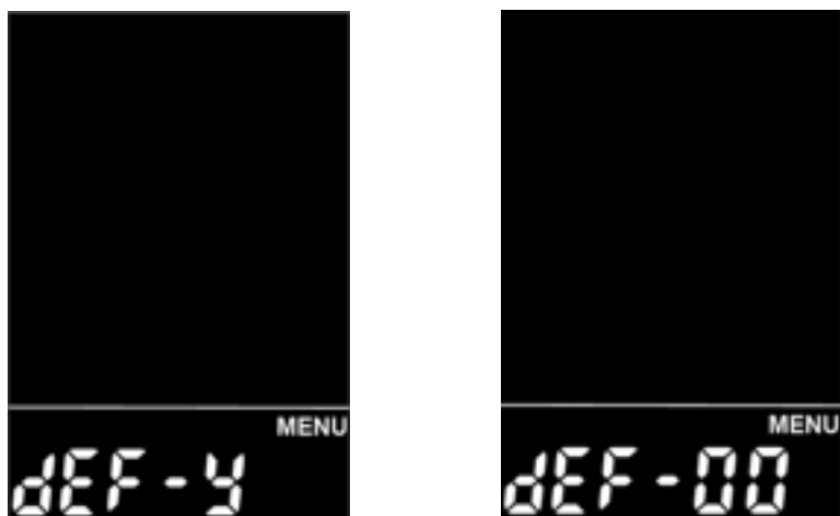
Ripristino dell'impostazione predefinita dell'interfaccia
