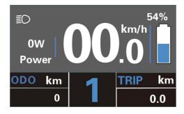
Interfaccia di indicazione della potenza del motore
